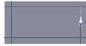
Step 4: V-groove cutter se, jo bazar mein aasani se mil jata hai, groove bana lijiye
